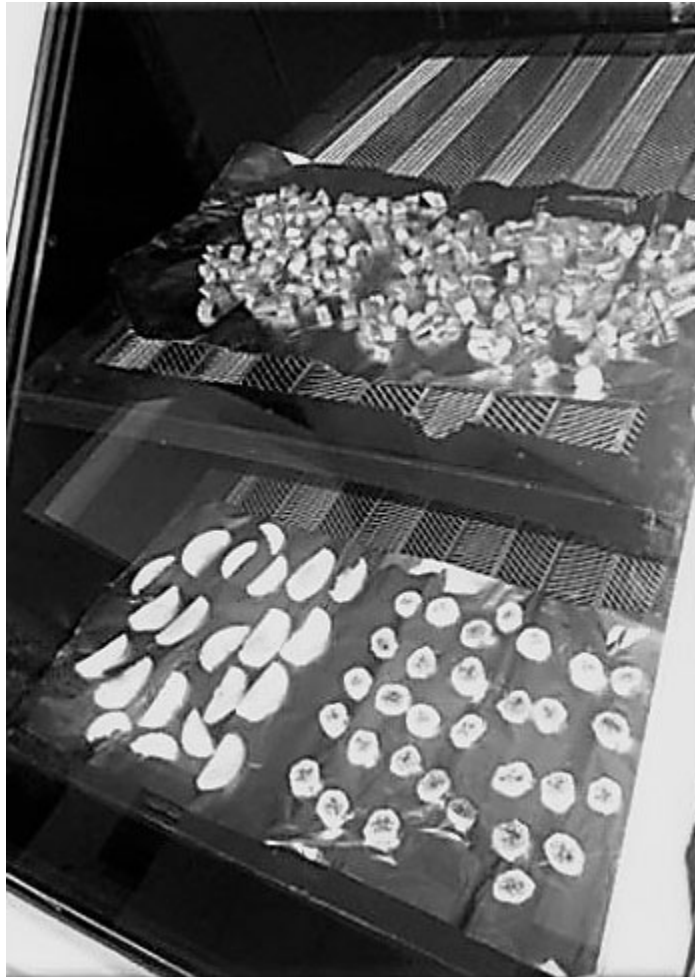
Figura 2: Deshidratación de Nopal Dentro del Prototipo de Deshidratador
