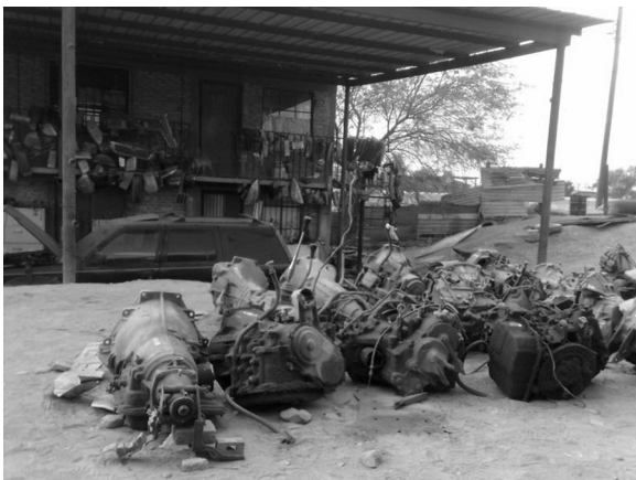
Figura 5: Transmisiones y Distintas Partes Acomodadas en Lugares sin Pavimento
