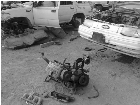
La Figura 7 muestra la falta de pavimento en áreas donde se requiere extraer fluidos como lo son aceites, líquidos de radiador y de frenos entre otros. Fotografía tomada por Cesar Sánchez Ocampo en Marzo de 2010
