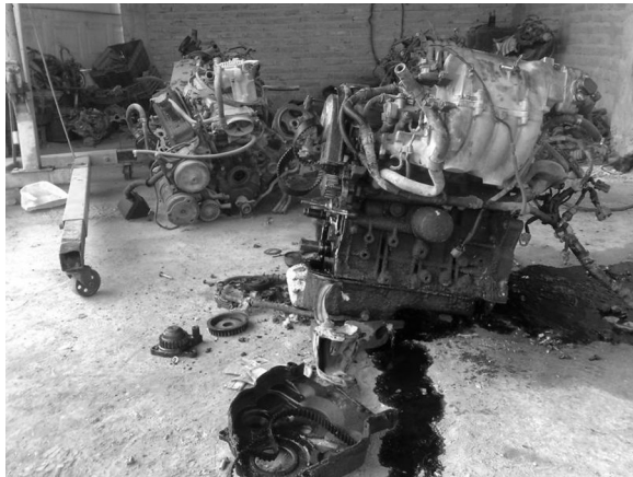
Figura 6: Fuga de Fluidos sin Control Alguno
